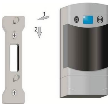
Рисунок 5 – Установка сигнализатора на монтажную панель
