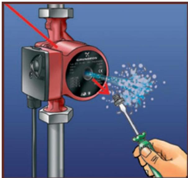
Сухой ход циркуляционного насоса с мокрым ротором.
